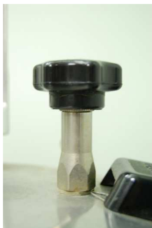
certokláv gőz kieresztő csapja zárt állásban
