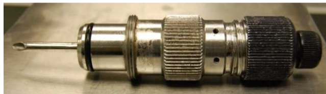
elmenő levegőszelep összerakott állapotban
