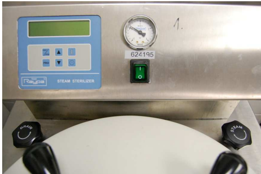
csatorna (drain) és gőz (setam) csap zárva
