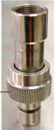
oldott oxigén elektróda rögzítő csöve
