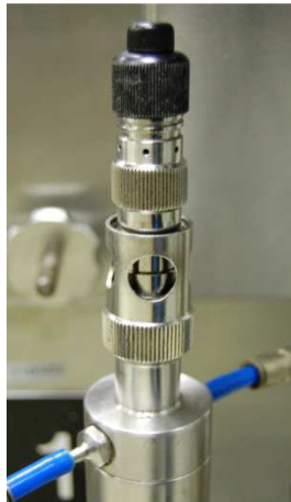
betekert levegőszelep fedéllel
