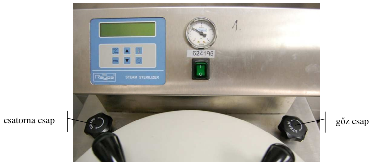
csatorna (drain) és gőz (steam) csap nyitva
