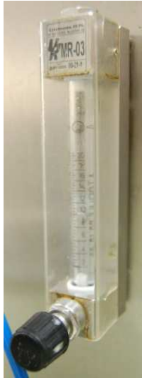
beállított rotaméter (például 8 l/min)
