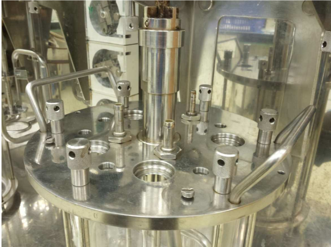
szorítócsavarokkal rögzített fedél
